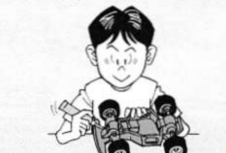
⑧ ギヤや輪受け部、サスペンションなどの可動部はグリスをさしておきましょう。
