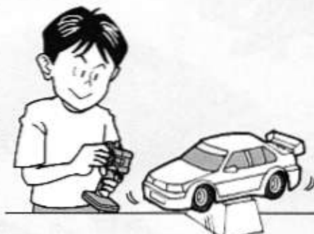
③ 走らせる前にRCカーを台の上に乘せ、各部の動きをチェックします。
