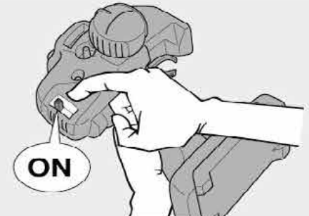
① スイッチをONにします。アンテナ付き送信機の場合はアンテナをのばしてください。
