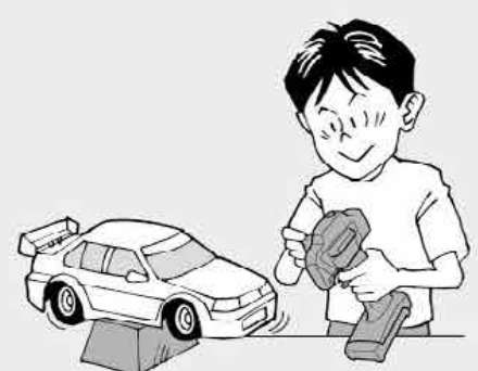
③ 走らせる前にRCカーを台の上に乗せ、各部の動きをチェックします。
